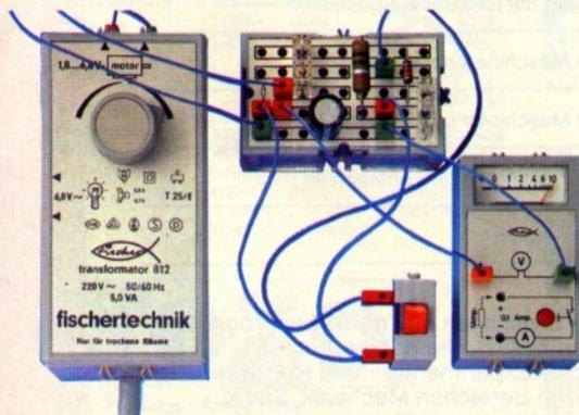
Messung der Entladung eines Elektrolyt-Kondensators
