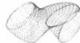
Ersetzen Sie einmal das Zahnrad Z 15 durch ein solches mit 20 Zähnen. Die Achse für den Schreibarm paßt dann in eine andere Nut des als Lager dienenden Bausteins (siehe Bild 29.4). Es ergeben sich annähernd dreieckige Figuren (Bild 28.3). Läßt man dagegen ein Zahnrad Z 10 auf dem Hohlrad abrollen (Bild 29.5), so erhält man sich überschneidende Figuren (Bild 28.4).
