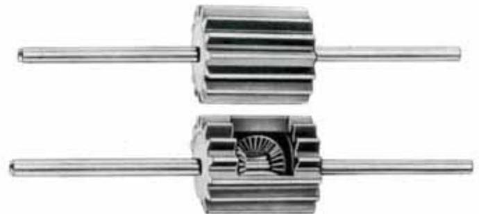
32.1 Kegelrad-Planetengetriebe (Differentialgetriebe)
