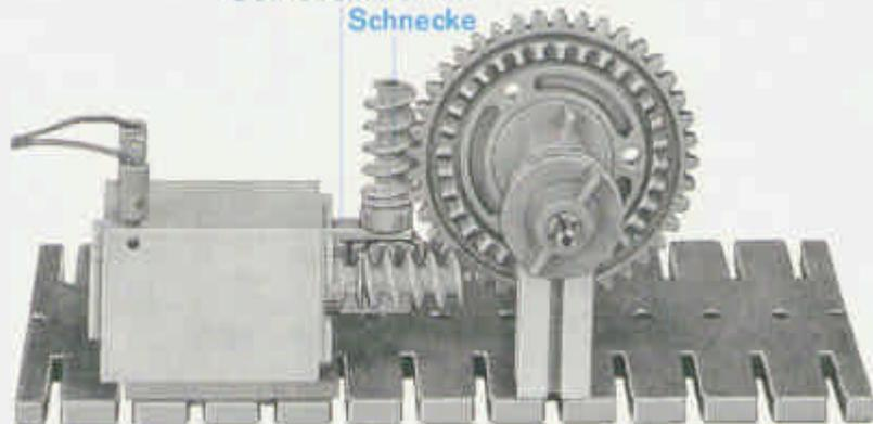
Durch das Ansetzen des Getriebehälters (mit Schnecke) sind Untersetzungen möglich, die bei langsamer Geschwindigkeit eine hohe Kraft ergeben. Diese Antriebsart eignet sich u. a. besonders für Krane und Bewegungsabläufe mit geringer Drehzahl.
