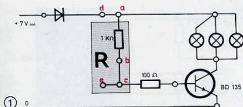
• Stecke den anderen 1-k $\Omega$ -Widerstand neben die Drahtbrücke; wie reagieren Lämpchen und Transistor, wenn Du die Brücke ziehst und dadurch  $R = 2 \text{ k}\Omega$  wird?
