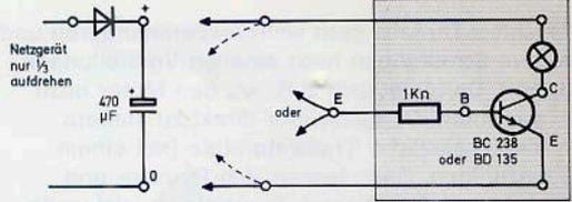
Achte darauf, daß das Netzgerät nur ganz wenig aufgedreht werden darf. Andernfalls könnte Dein Transistor beim Prüfen zerstört werden.
