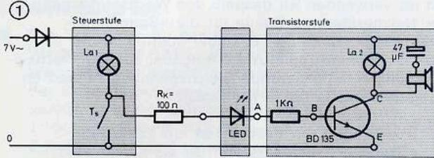
■ Am besten baust Du gleich die Versuchsschaltung (1) auf. Spaßeshalber setzen wir eine kombinierte Seh- und Höranzeige ein; die Versorgungsspannung wird deswegen nicht geglättet. Die vom 1-k $\Omega$ -Widerstand gleich mitgeschützte LED soll anzeigen, ob ein Steuerstrom fließt oder nicht. Mit dem 100- $\Omega$ -Widerstand koppelst Du die Transistorstufe an den »Steuerteil« der Schaltung an.
