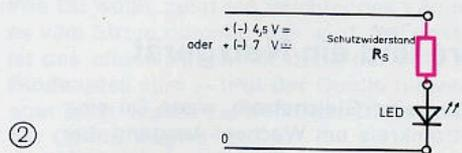
Als Schutzwiderstand  $R_s$  verwenden wir (wenn nichts anderes gesagt wird) einen 1-k $\Omega$ -Schichtwiderstand (br-sw-rt); (1 k $\Omega$  = 1000  $\Omega$ ).
