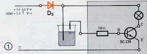
Da die »obere« Schiene von jetzt ab mit Sicherheit immer mit dem (+)Pol der Quelle verbunden ist, nennen wir sie einfach **Plusschiene**. Die untere bezeichnen wir im Gegensatz dazu als **Nullschiene**; im Schaltplan steht deshalb eine Null dabei. Auf diese Null werden sozusagen alle Voltangaben bezogen (siehe auch Seite 12).
