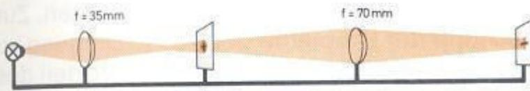
Der Abstand zwischen Linsenlampe und Kreuzblende soll  $150\text{ mm} = 5$  Bausteine, betragen. Verschieben Sie die linke, dicke Linse so lange, bis die Blende möglichst hell beleuchtet ist. Dann verschieben Sie die andere Linse, bis das Kreuz genau und scharf auf dem Schlitz der Auffangfläche (Schlitzblende) abgebildet ist. Statt der Kreuzschlitzblende können Sie auch ein Diapositiv verwenden. Dann muß auf der Auffangfläche ein kopfstehendes Abbild erscheinen.
