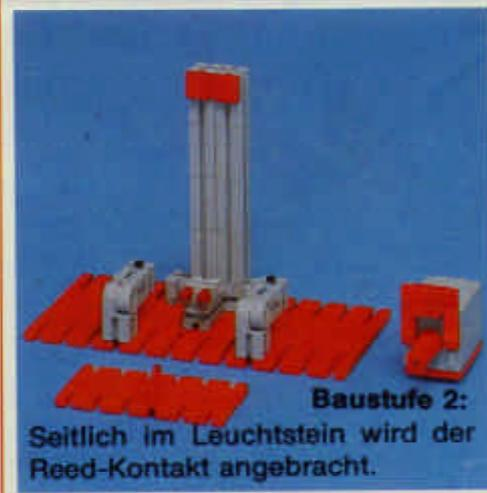
**Baustufe 2:** Seitlich im Leuchtstein wird der Reed-Kontakt angebracht.
