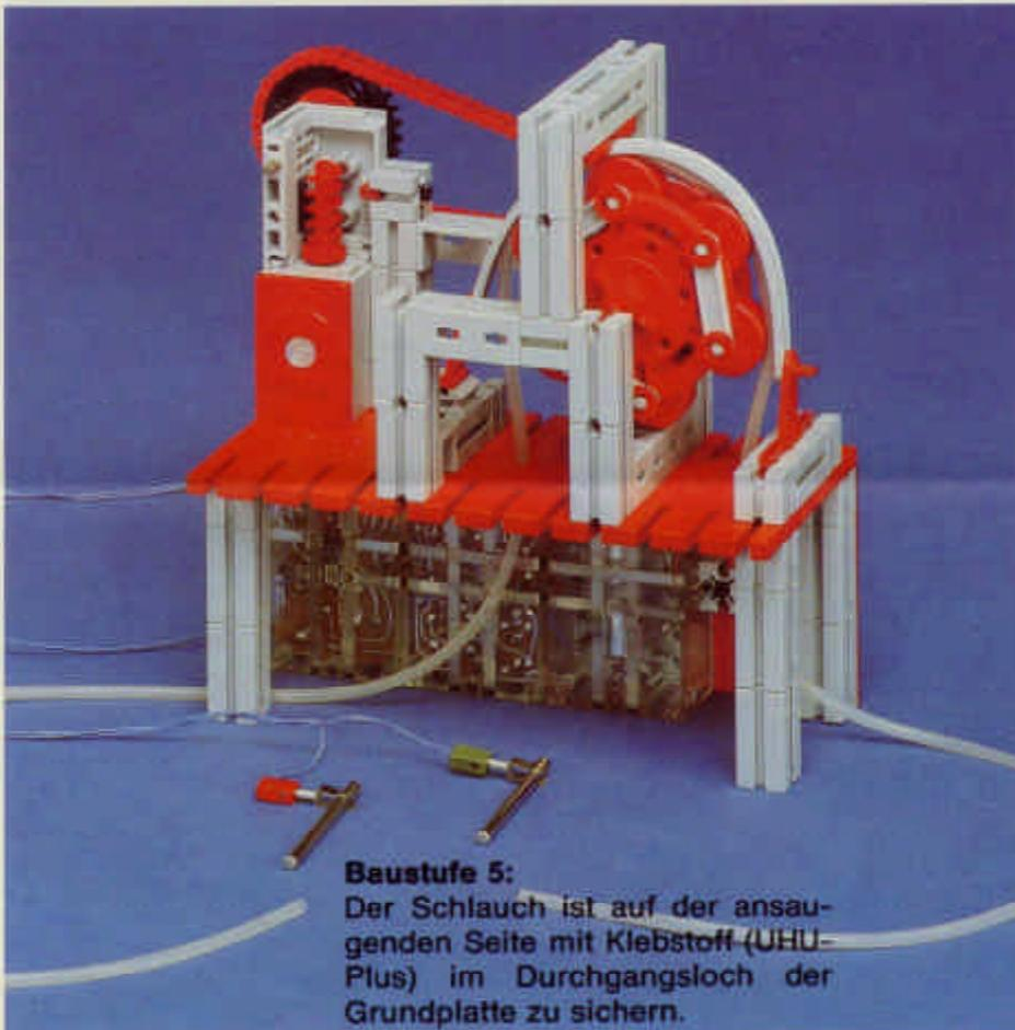
**Baustufe 5:** Der Schlauch ist auf der ansaugenden Seite mit Klebstoff (UHU-Plus) im Durchgangsloch der Grundplatte zu sichern.
