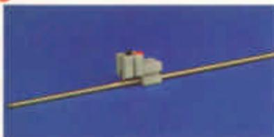
Aus zwei Bausteinen 15, einem Verbindungsstück 15, einer Steckachse und einem Federkontakt bauten wir eine Stromschiene. Dies ist eine einfache Lösung zur Stromabnahme bei beweglichen Modellen, die anscheinend vielen Clubmitgliedern Probleme bereitet.
