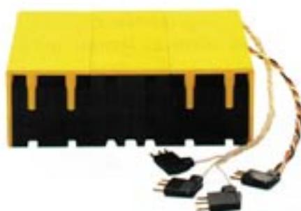
Der 4 Kanal Motor-Controller hat 2 Proportionalkanäle (Fahrtregler) und 2 Digitalkanäle (Relais). Die Funktionen sind folgendermaßen ausgelegt:
