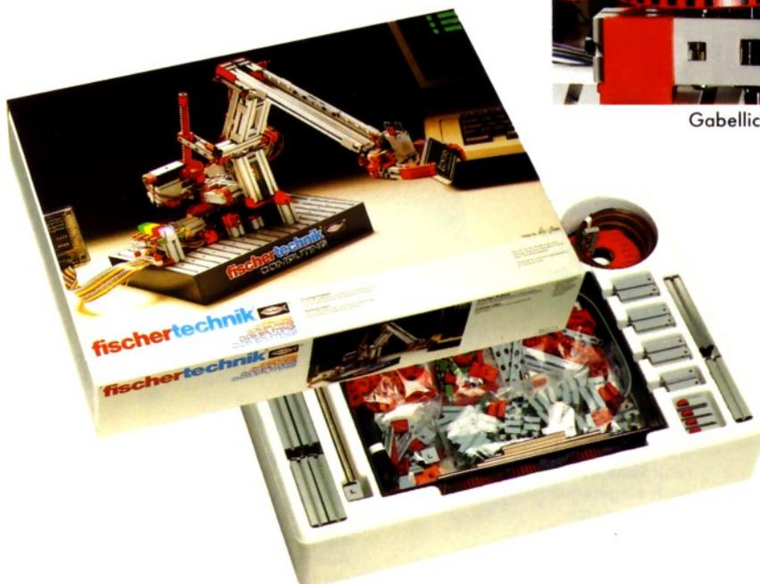
Das Positioniersystem des Trainingsroboters arbeitet mit 3 Infrarot-Gabel-Lichtschranken. Mit der motorbetriebenen Greifhand können Teile bis zu 100 g bewegt werden.
