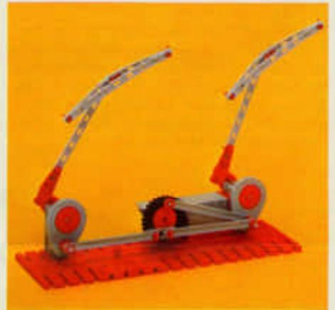
Unentbehrlich bei Regen und Schnee ist an jedem Auto ein Scheibenwischer. Er wird durch einen kleinen Elektromotor angetrieben. Die metallenen Arme, an denen sich Gummiwischer befinden, bewegen sich auf der Windschutzscheibe hin und her. Zum Säubern der Scheibe können die Wischer zurückgeklappt werden.
