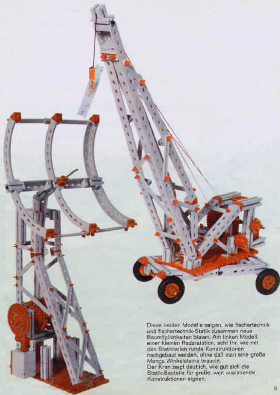
Diese beiden Modelle zeigen, wie fischertechnik und fischertechnik-Statik zusammen neue Baumöglichkeiten bieten. Am linken Modell, einer kleinen Radarstation, seht Ihr, wie mit den Statikteilen runde Konstruktionen nachgebaut werden, ohne daß man eine große Menge Winkelsteine braucht. Der Kran zeigt deutlich, wie gut sich die Statik-Bauteile für große, weit ausladende Konstruktionen eignen.
