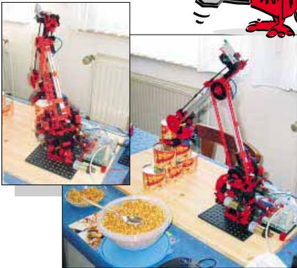
Diesen Sachsignen Roboter mit drehbarem pneumatischem Greifer, der Erdnuss-Dosen stapelt, hat Heiko Engelke entwickelt. Das Modell wird über ein Gamepad bedient.
