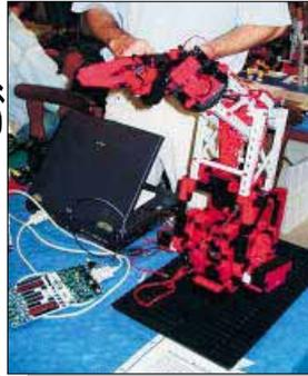
Elektronik-Profi Frank Linde hat diesen 5-Achs-Roboter als Teil eines autonomen Robotersystems konstruiert.
