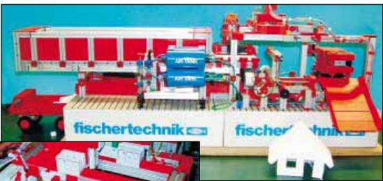
„fischertechnik Fertighaus GmbH“: Der computergesteuerte Styroporschneider von Manfred Busch (fischertechnik-Freunde Mörs) produziert sechs hochpräzise Teile, mit denen sich passgenau ein Häuschen zusammensetzen lässt! Sehr beliebt z.B. bei Kindergärten...
