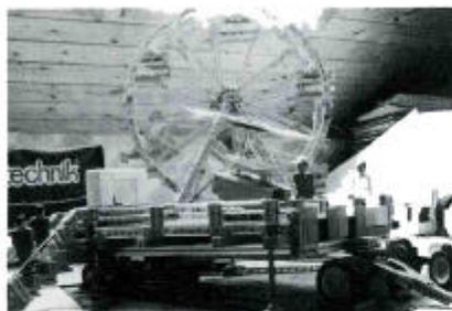
Zum Aufbau von aufwendigen, transportierbaren Anlagen, wie z.B. einem Karusell, benötigt man diesen Tieflader. Seine Hinterachsen sind lenkbar und an jeder Seite sind Sicherheitsstützen angebracht, um ein Kippen zu verhindern.
