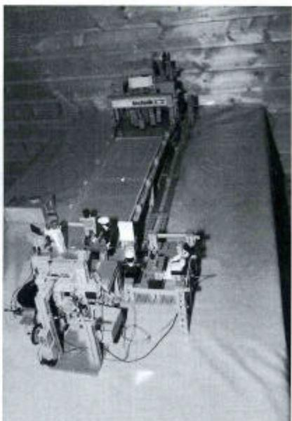
Der Wurf auf "Alle Neune" wird durch einen Geldautomaten gestartet. Die Spielkegelbahn ist mit einer Kegel-Aufstellautomatik, einem Zeitschalter, Rot-Grün-Schaltung, Kugelablauf, Kugelfang und einer Bahnbeleuchtung ausgestattet.
