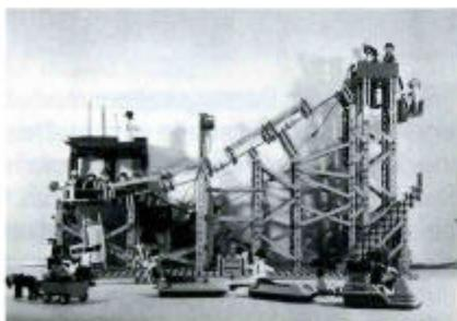
Inspiziert durch seine Freunde, die aktive Skispringer sind, entstand die Idee, eine Sprungschanze zu bauen. "Die Schanze besitzt einen Aufzug, der mit Hilfe von Motor, Getriebe und Schneckenantrieb läuft. Eine motorbetriebene Schranke mit zusätzlichen
