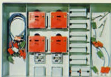
Der Lernbaukasten enthält alle zum Bau von einfachen Rechenschaltungen notwendigen Teile. Das Grundelement ist der speziell für diese Anwendung konstruierte Schalter, der sowohl als Ein- als auch als Austaster zu verwenden ist. Mehrere Schalter können miteinander gekoppelt werden, gleich welche Schaltseite verwendet wird.
