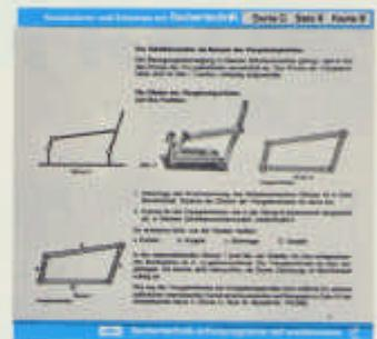
Serie C Satz II – Umwandlung einer Drehbewegung in eine Schwingbewegung beim Scheibenwischer (Kurbelschwinge) 6. – 8. Schuljahr – für u-t 1
