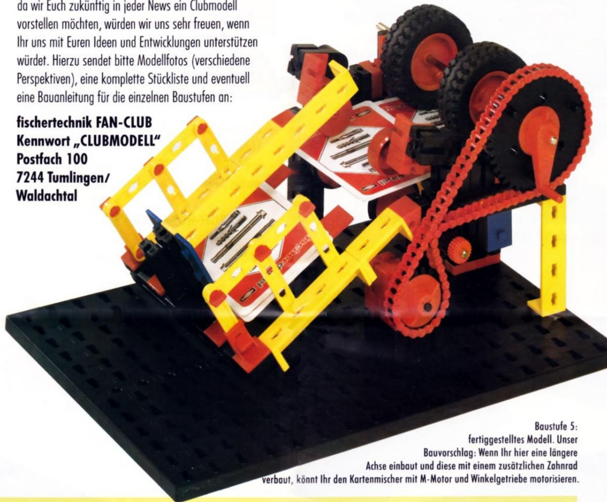
Baustufe 5: fertiggestelltes Modell. Unser Bauvorschlag: Wenn Ihr hier eine längere Achse einbaut und diese mit einem zusätzlichen Zahnrad verbaut, könnt Ihr den Kartenmischer mit M-Motor und Winkelgetriebe motorisieren.
