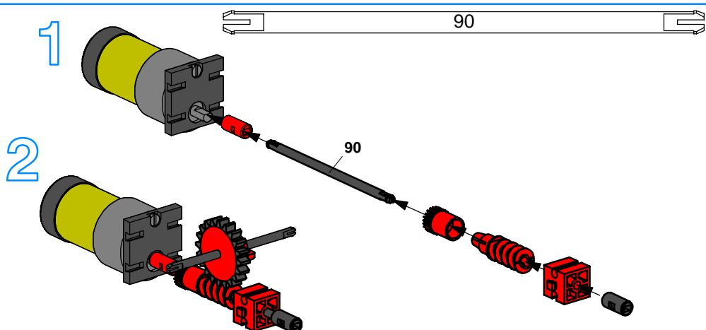
Differentialgetriebe für Radantrieb
